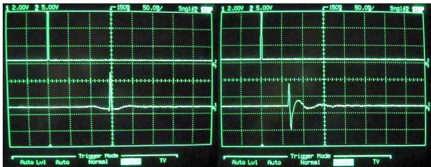
Однополярный импульс 5 мс в линейно-фазовом режиме и минимально-фазовом режиме
