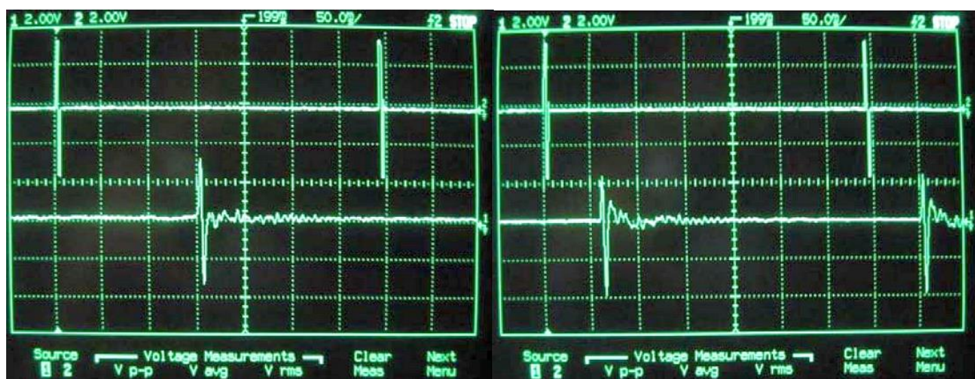
Биполярный импульс длительностью 2 мс в линейно-фазовом режиме и минимально-фазовом режиме.
