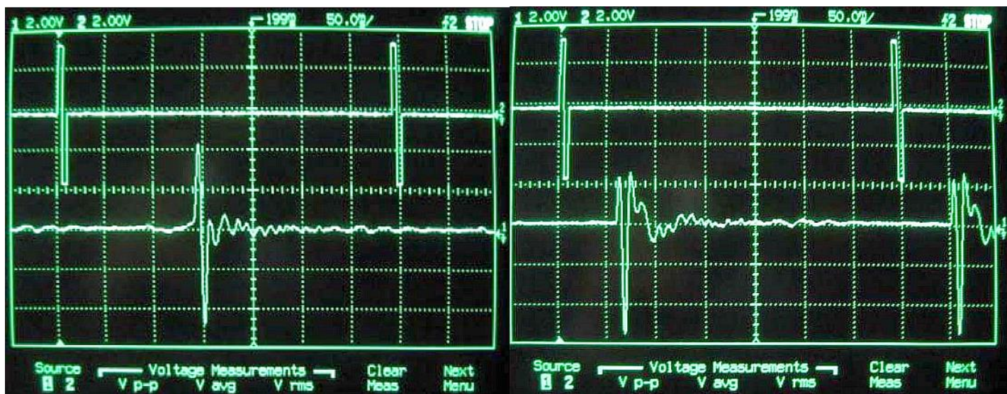
Биполярный импульс длительностью 10 мс в линейно-фазовом и минимально-фазовом режимах
