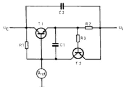
На рисунке 4 показана схема блока питания. Т1 - продольный транзистор, основание которого находится под стабильным напряжением  $U_{REF}$ . Таким образом,  $U_A$  хорошо просеивается и
