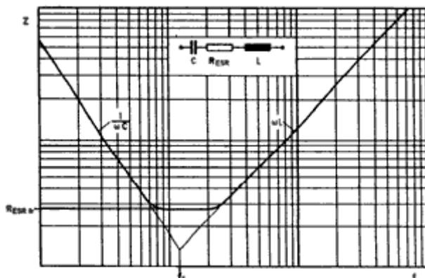
На рисунке 9 показан идеализированный график импеданса типичного Elkos и его схема замещения. Отдельные части схемы замены определяются следующим образом:
