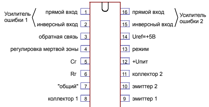
Рис. 11. Управляющая микросхема TL494 и ее цоколевка.
