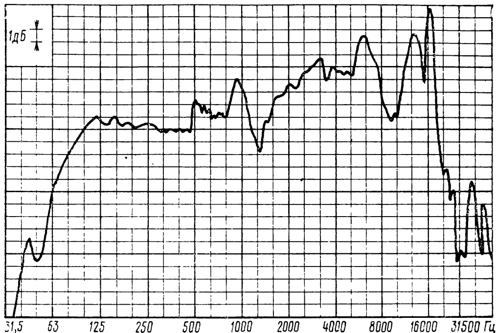
Рис. 1.83. Форма АЧХ звукового давления 15АС-214, измеренной по акустической оси
