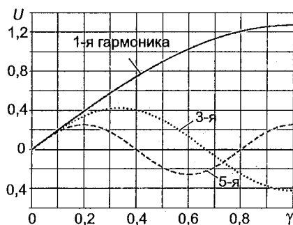
Рис. 7.6. Зависимости амплитудных значений (для 1-й, 3-й и 5-й гармоник) выходного напряжения инвертора от \gamma
