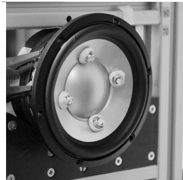
Рис. 3. Мидвуфер SEAS L16RNX (H1488-08), установленный в стойку с дополнительной массой m_2 .
