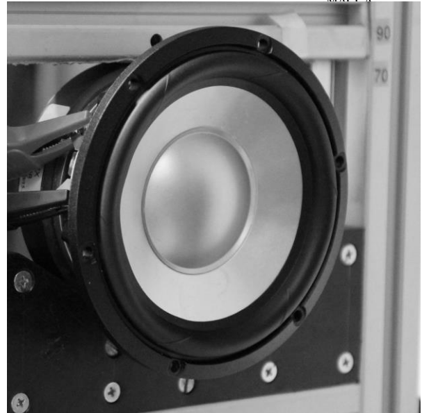
Рис. 1. Мидвуфер SEAS L16RNX (H1488-08), установленный в стойку.
