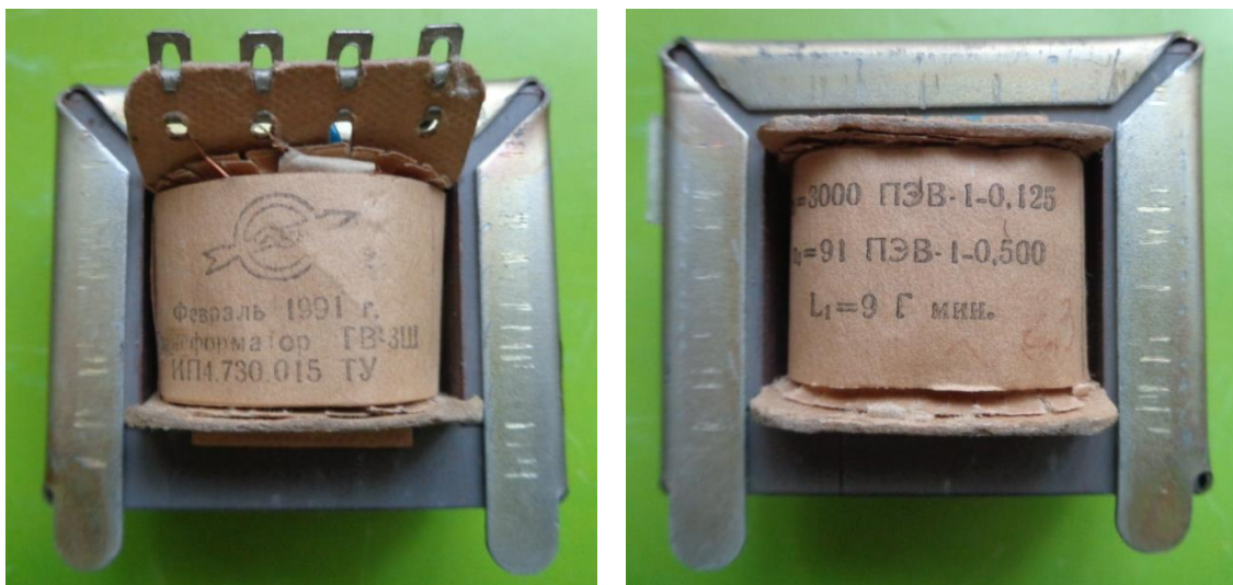
рис. Внешний вид и заводские характеристики ТВЗ-3Ш.
