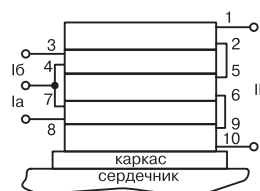
Рис. 8.11. Схема расположения обмоток трансформатора
