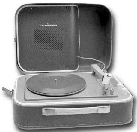
рис.3.Проигрыватель с пьезоэлектрической головкой звукоснимателя. 60-ые годы XX века.
