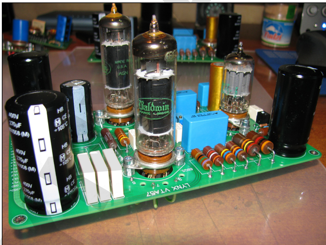
Рис. 3 Вид платы усилителя мощности
