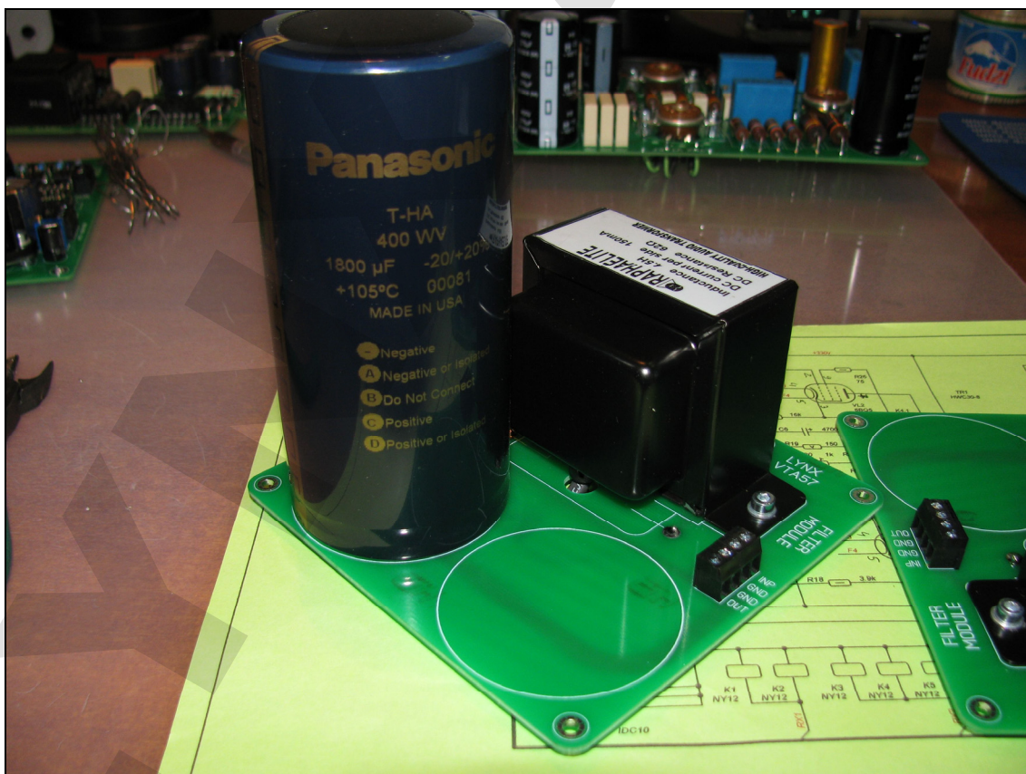
Рис. 5 Вид платы усилителя фильтра анодного питания
