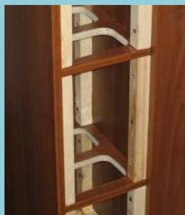
Распорки выполнены из ДСП
