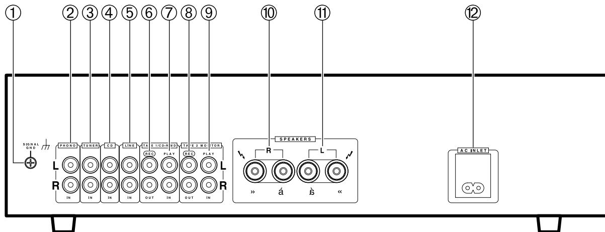
① GND (терминал заземления для проигрывателя пластинок)
