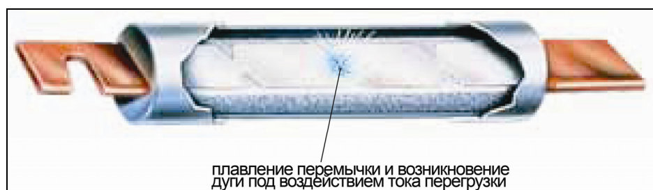
Рис. 5. Срабатывание плавкого предохранителя под воздействием тока перегрузки
