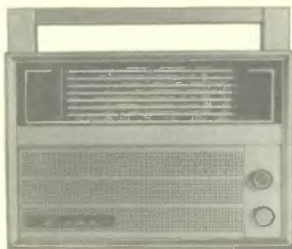
8-диапазонный переносный супергетеродинный приемник [конструктор Л. Морозов, г. Москва, поощрительный приз]
