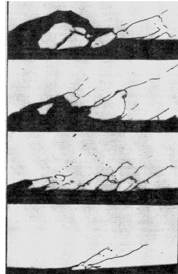
Рисунок 4.17– Выкрашивание поверхности ролика по мере увеличения числа циклов нагружения
