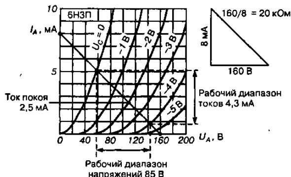
Рис. 9.1. Нагрузочная прямая на семействе характеристик лампы
