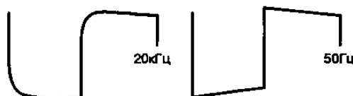
Рис. 21.8. Осциллограммы сигнала выходе усилителя при подаче на вход меандра частотой 20 кГц и 50 Гц
