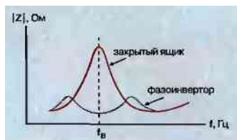
Рис. 4. Зависимость модуля полного сопротивления АС от частоты. Максимум или минимум вовсе не означает пик АЧХ
